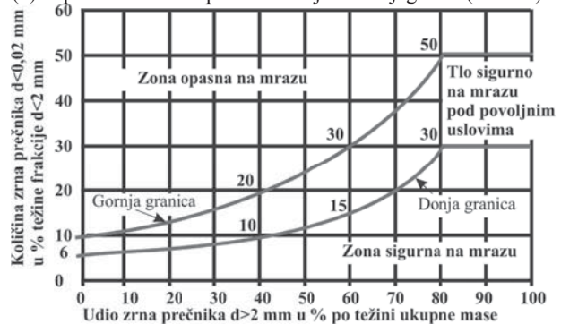
Sl. 4. Dijagram za ocjenu osjetljivosti tla na mraz po Rukljevom kriteriju
