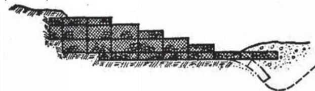
Sl. 44. Naper od gabiona
