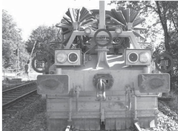
Slika 2. Stroj za planiranje tucanika opremljena ultrazvučnim senzorima za automatsko zaustavljanje kada se radnik nađe u bliskom prostoru ispred stroja
