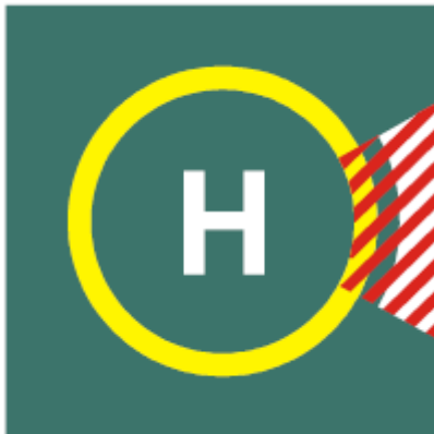
SLIKA 5-7: Oznake za zabranjeni sektor na helideku
