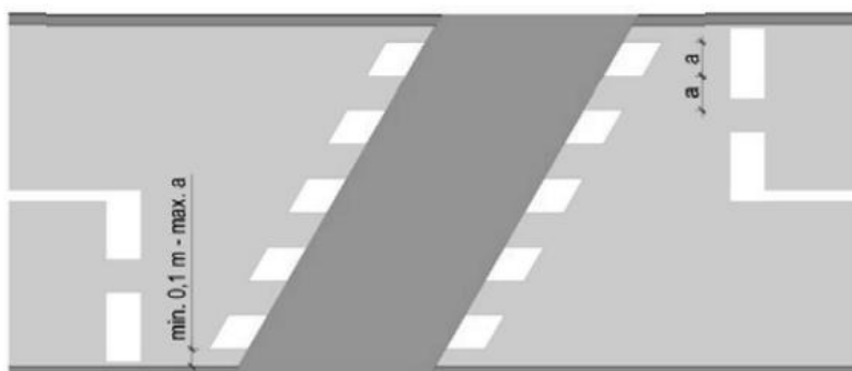
Slika 47. Kosi prelaz biciklističke staze ili biciklističke trake preko kolovoza
