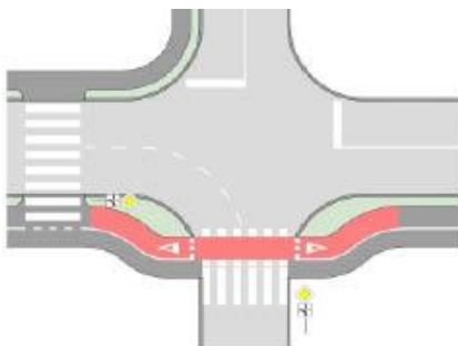
Slika 24. Vođenje biciklističkog saobraćaja preko sporednog puta sa prvenstvom prolaza
