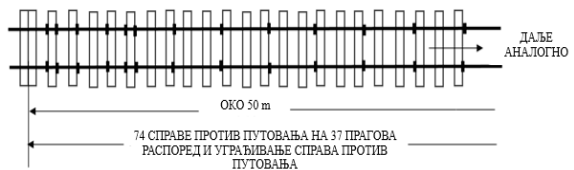
Слика 3. Скица постављања справа против уздужног путовања шина
