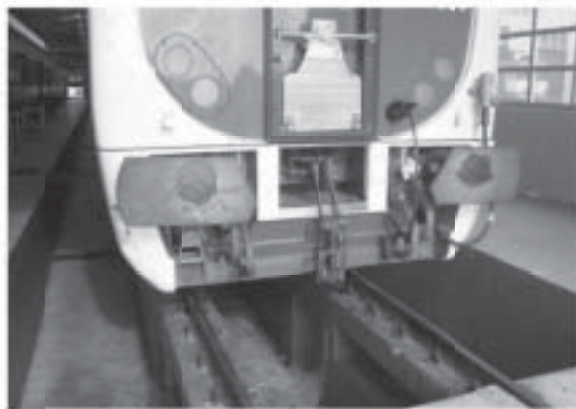
Slika 1. Krajnja strana "Talgo" garniture sa odbojničkim i uređajima za kvačenje.
